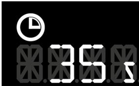
Zone pour le réglage temps et le compte à rebours lorsque la presse est fermée
