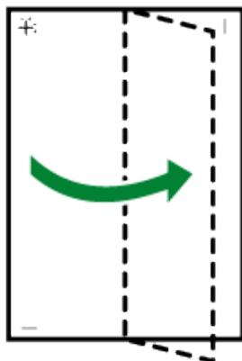
**7** La valeur d'ajustement optimale correspond à la différence entre la seule ligne verticale et la ligne verticale de la croix visible lorsque le papier plié est éclairé. Lorsque cette différence est une marque d'étalonnage dans le sens "+", la valeur d'ajustement optimale pour [Sens de lecture] est "+1,0".
