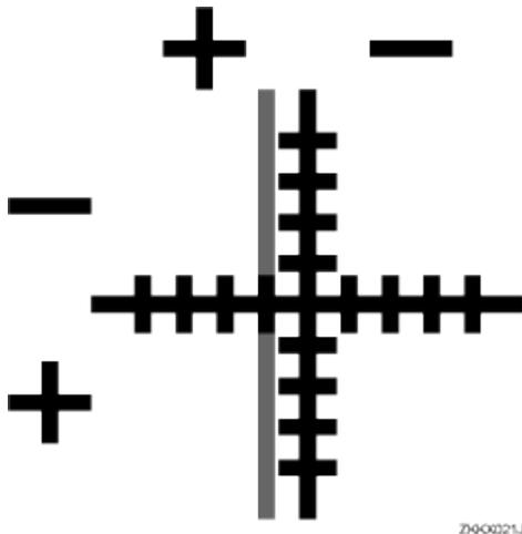
**8** Pliez la feuille de test en deux sur sa largeur, puis vérifiez la valeur d'ajustement pour [Sens d'alim.]
